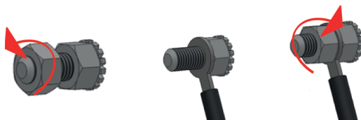
Figura 4. Conexión del equipo a una instalación equipotencial.
