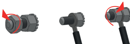
Rys. 4. Podłączenie urządzenia do instalacji wyrównującej potencjały elektryczne.
