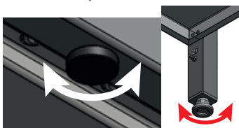
Figure 7. Mise à niveau de l'appareil
