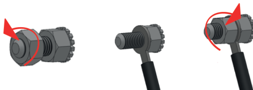
Figura 10. Conexión del equipo a una instalación equipotencial.
