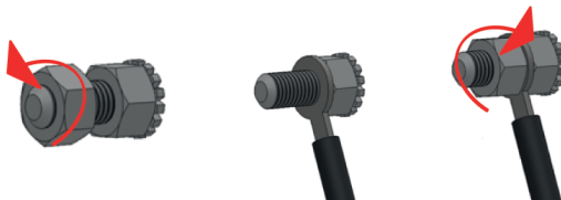
Figura 10. Conexión del equipo a una instalación equipotencial.
