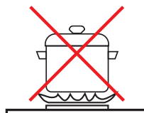
Příliš malé dno pro příslušný hořák
