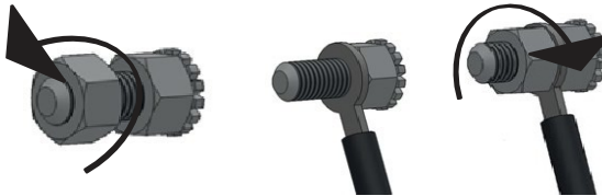
Abb. 4: Anschluss des Geräts an das elektrische Potentialausgleichssystem.
