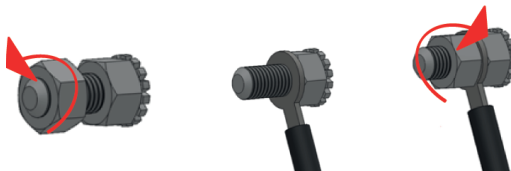
Figura 4. Conexión del equipo a una instalación equipotencial.
