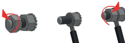
Rys. 4. Podłączenie urządzenia do instalacji wyrównującej potencjały elektryczne.
