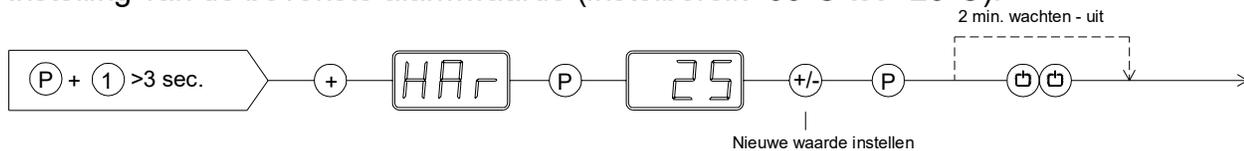
Instelling van de onderste alarmwaarde (instelbereik  $-35^{\circ}\text{C}$  tot  $+25^{\circ}\text{C}$ ):
