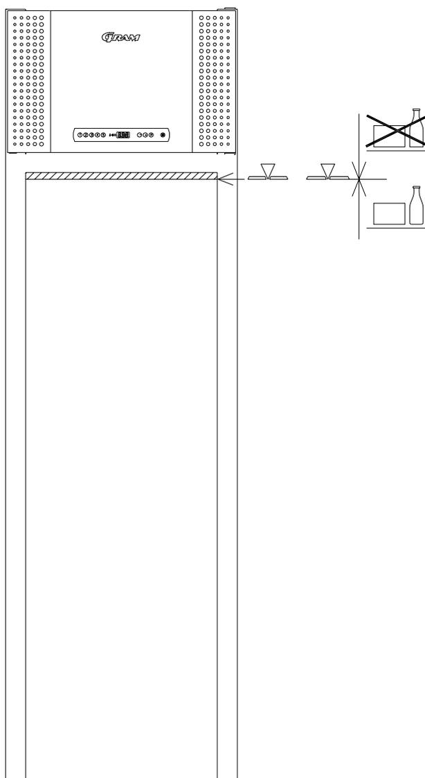
Alle varer, som ikke er emballeret i forvejen, og som skal opbevares i skabet, tildækkes for at forhindre unødigt korrosion af skabets indre dele, herunder bl.a. fordampere.
