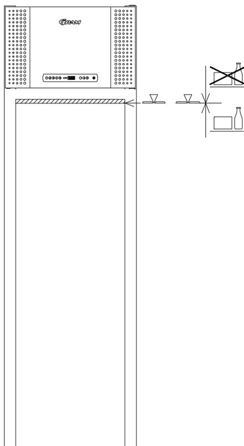
Alla varor, som inte är förpackade i förväg och som skall förvaras i skåpet, skall förslutas för att förhindra onödig korrosion av skåpets inredning, bl. a. kylelementet.
