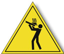
Die seitige Etikette ISO 3864-1 muss auf eine sichtbare Oberfläche aufgeklebt werden, auf eine Höhe von 1.6 Mt vom Boden.
