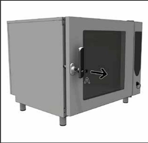
Nachdem man die Tür in die neue Position befestigt hat, wird der Türgriff umgedreht. Um den Türgriff in die richtige Position zu setzen, entfernen Sie die runde Kappe und die Schraube unten abschrauben, die den Türgriff blockiert.
