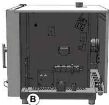
Durch das Entfernen der rechten Seitenwand, finden Sie auf Ofenboden die Etikette B.
